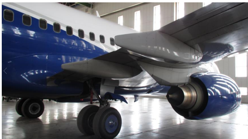
Foto 3: gambe carrello principale compresse.
