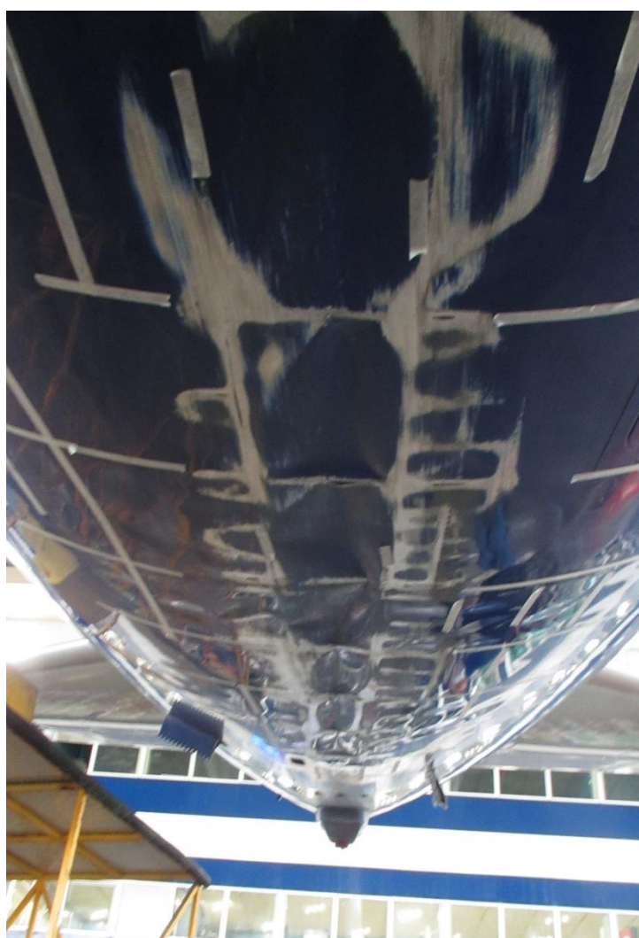
Foto 2: danneggiamenti riportati dall'aeromobile parte inferiore fusoliera posteriore e coda.
