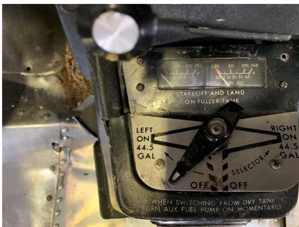
Foto 7: valvola selettiva del carburante.
