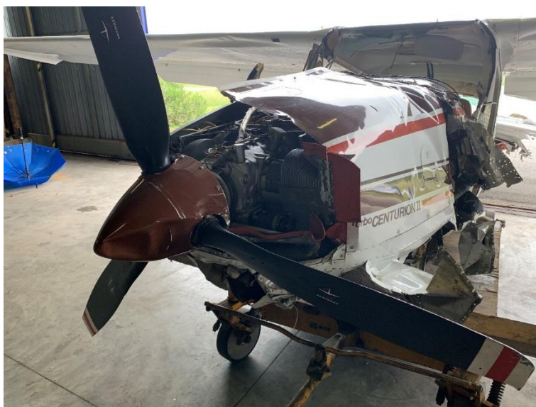
Foto 3: danneggiamenti parte anteriore del velivolo.
