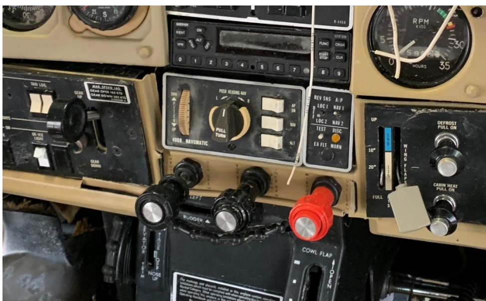
Foto 6: comandi leva carrello, throttle , passo elica, mixture , leva dei flap.
