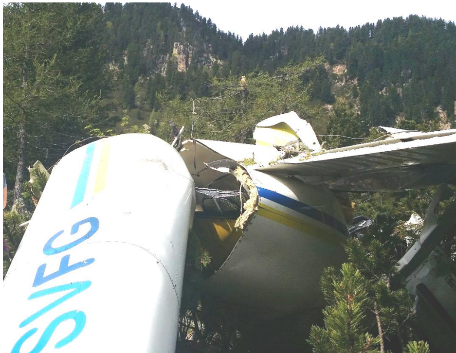
Foto 1: danneggiamenti trave di coda.
