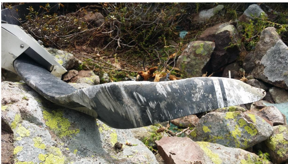
Foto 5: danneggiamenti di una pala dell'elica.
