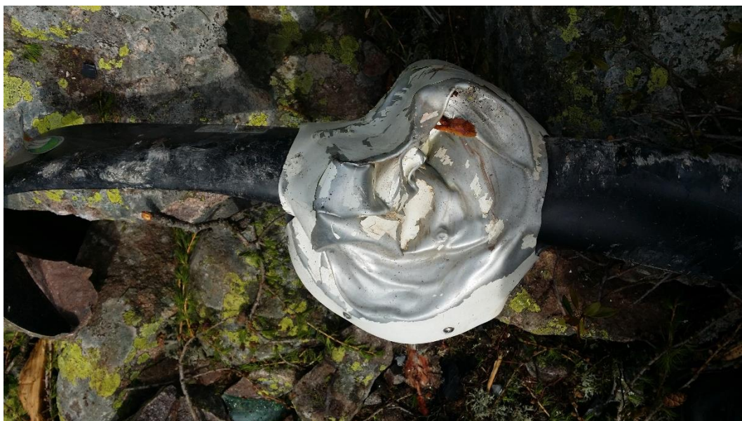
Foto 4: danneggiamenti ogiva dell'elica.
