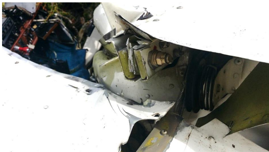
Foto 13: cavi e puleggia di rimando comandi semiala sinistra.
