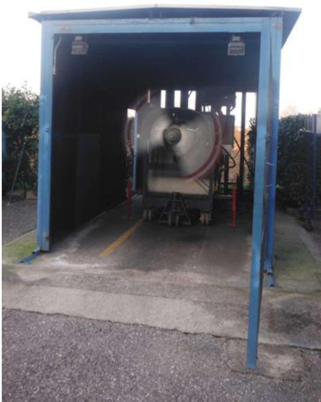
Foto 12: prova al banco del propulsore a diversi regimi di potenza.
