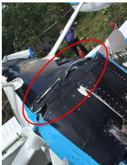
Foto 6: punto di cedimento della struttura a seguito dell’urto con il terreno.
