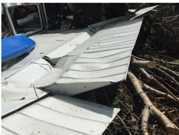
Foto 7 e 8: particolare dei flap e della posizione del relativo attuatore.
