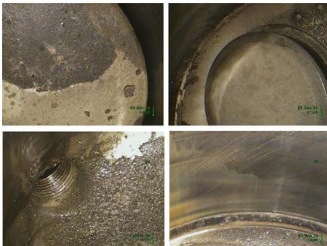
Foto 11: dettagli dell'analisi endoscopica dei cilindri.
