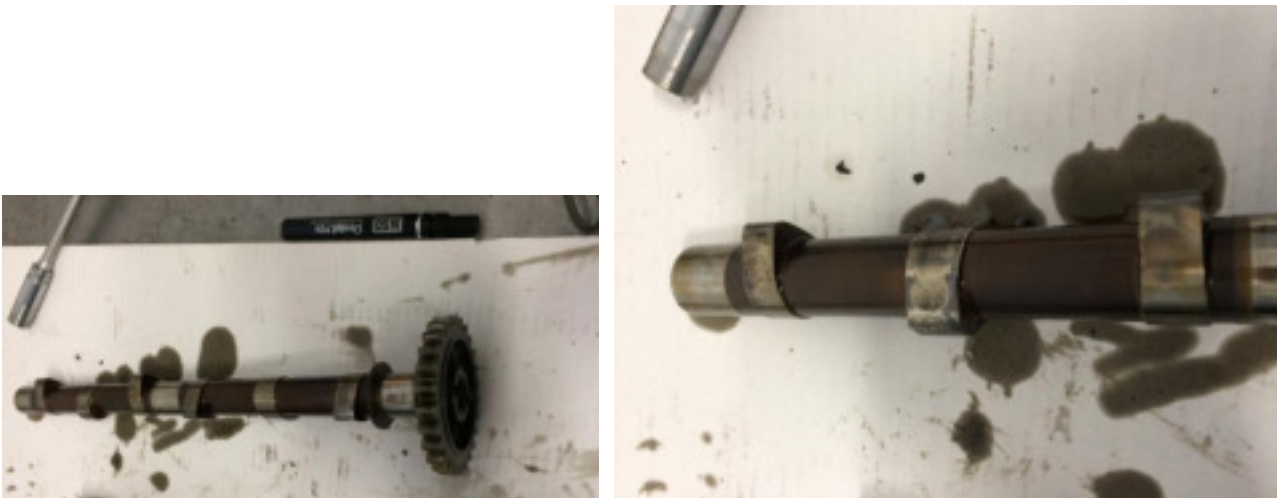
Foto 8 e 9: albero a camme del motore del C152 marche I-ECSO.
