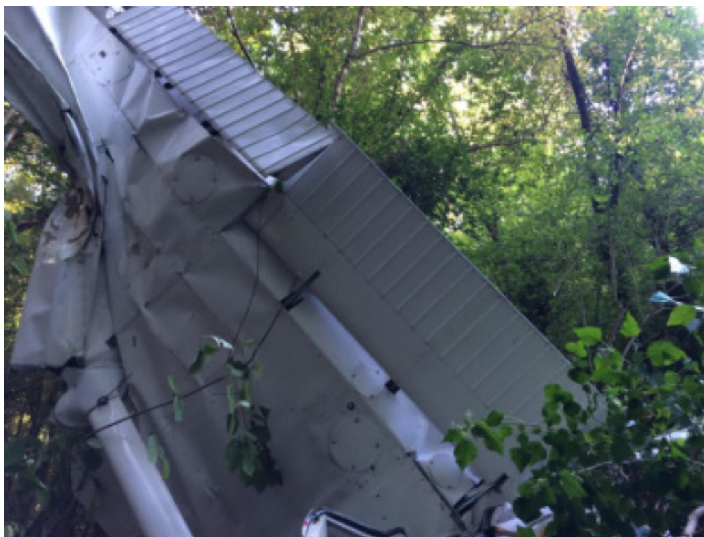
Foto 4: dettaglio del flap semiala sinistra del C152 marche I-ECSO.
