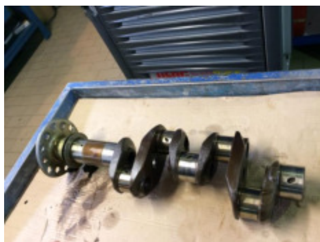
Foto 6 e 7: albero motore del C152 marche I-ECSO.
