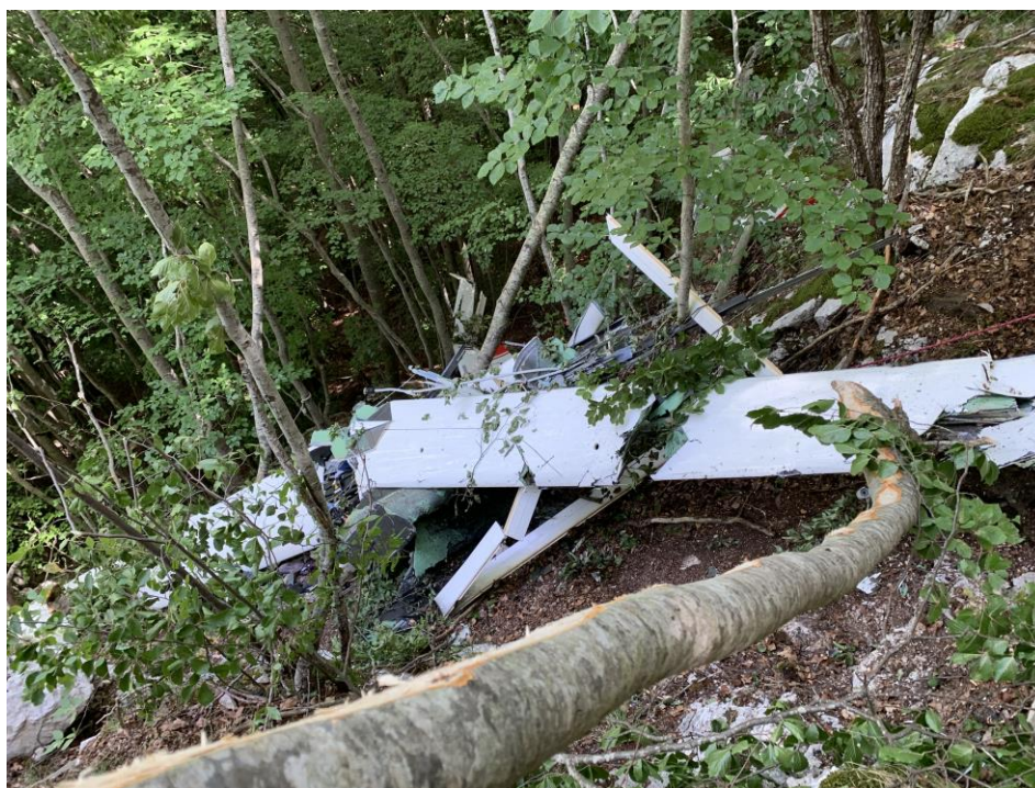
Foto 5: segni di interferenza tra arbusti e semiali del D-KVLS.
