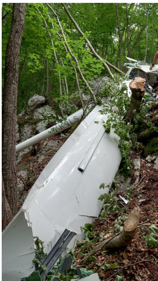
Foto 4: segni di interferenza tra arbusti e semiali del D-KVLS.
