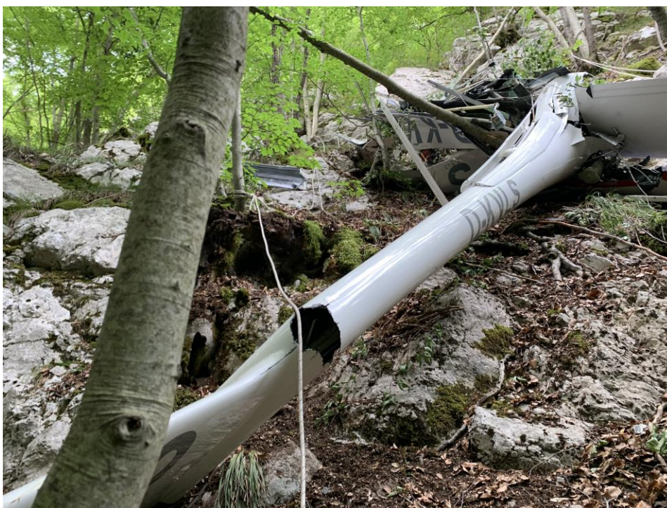
Foto 3: rottura della coda del D-KVLS.
