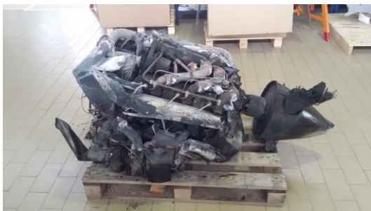
Foto 27: motore ed elica dopo separazione dal relitto.
