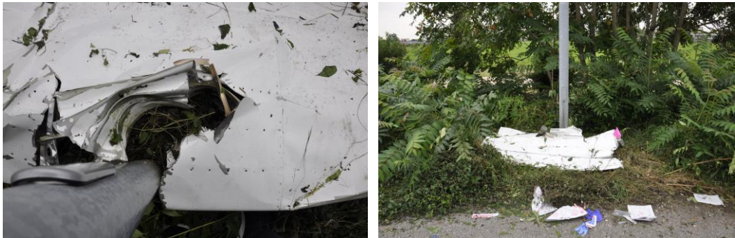
Foto 7 e 8: impatto estremità semiala sinistra contro un palo dell'illuminazione.
