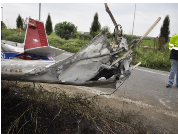
Foto 21: deformazione della estremità della semiala sinistra.
