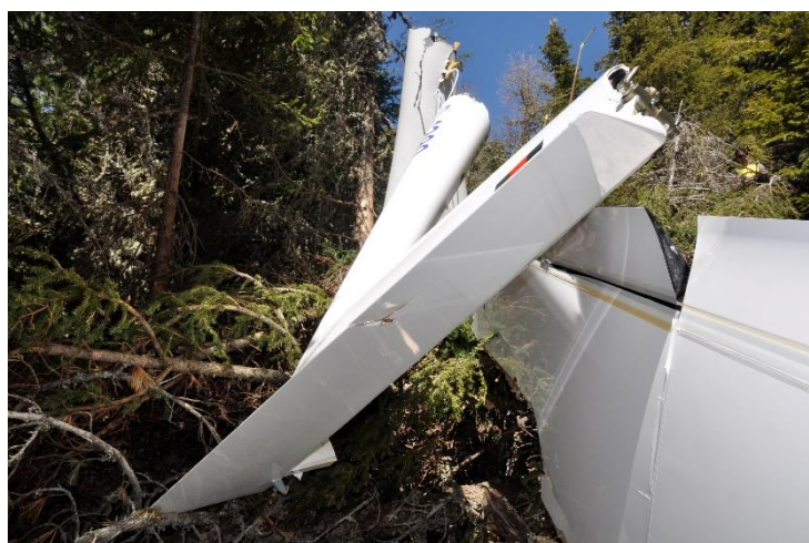
Foto 6: particolare trave di coda e timone di profondità.
