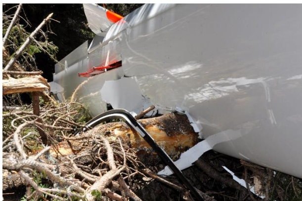
Foto 7: particolare del danneggiamento da impatto albero – semiala dx.
