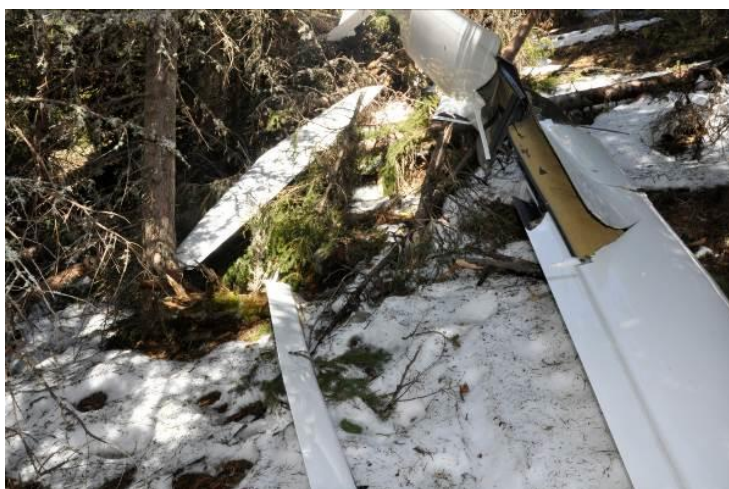
Foto 5: timone di profondità separato dalla struttura.
