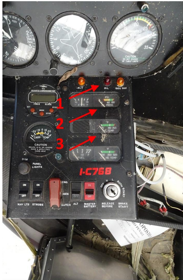
Foto 11: 1. spia bassa pressione olio lubrificazione motore (OIL); 2. indicatore pressione dell’olio (OIL PRESS); 3. indicatore temperatura dell’olio (OIL TEMP).
