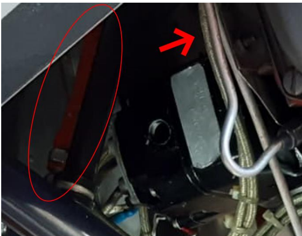
Foto 12: ingrandimento della precedente fotografia 6, che sarebbe stata inviata dal tecnico manutentore al pilota proprietario dell'I-C768; nell'ovale è evidenziato l'andamento della tubazione di connessione del sensore della pressione dell'impianto di lubrificazione rispetto al punto di innesto nel motore indicato dalla freccia.
