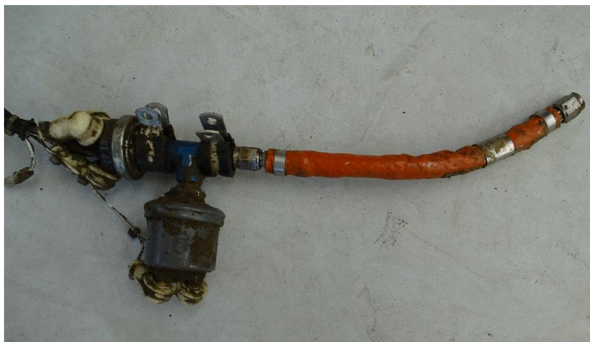
Foto 10: il sensore della pressione dell'impianto lubrificazione motore e relativa tubazione.
