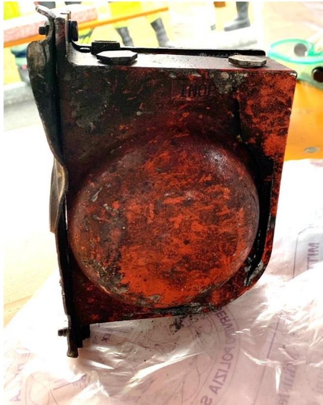
**Il LDR che era a bordo del Pilatus PC-12 marche YR-PDV. I dati contenuti nello stesso, che si era fortemente danneggiato a seguito dell'incidente, sono stati estratti e analizzati presso i laboratori tecnologici dell'ANSV.**
