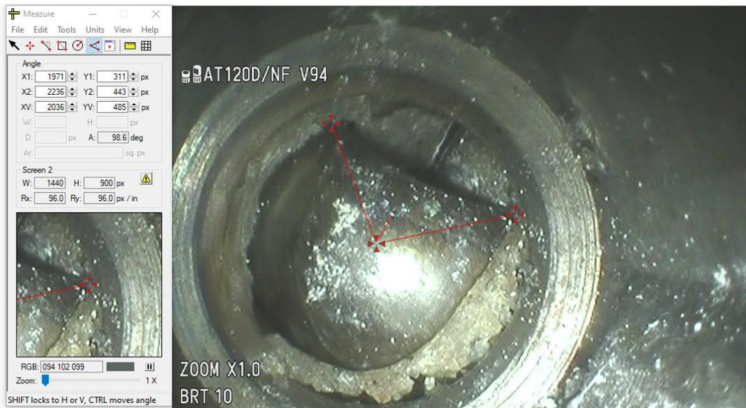
**Misurazioni geometriche su immagine catturata mediante video-endoscopio durante una analisi condotta dai laboratori ANSV.**
