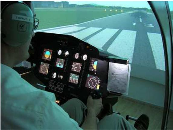
per una simulazione ed un realismo di alta formazione, comprendente avionica, radar, GPS e altre strumentazioni sofisticate e di ultima generazione. «Questa apparecchiatura - prosegue Baldazzi - è anche dotata di tre proiettori che riproducono su uno schermo ellittico lo scenario di volo; anche i comandi e le vibrazioni sono in tutto e per tutto corrispondenti ad una reale situazione di
